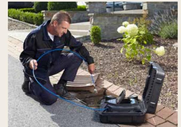
Mit der 20 m langen Schubstange und dem dreh- und schwenkbaren Farbkamerakopf entgeht Dir auch in der Hausanschlussleitung nichts.
