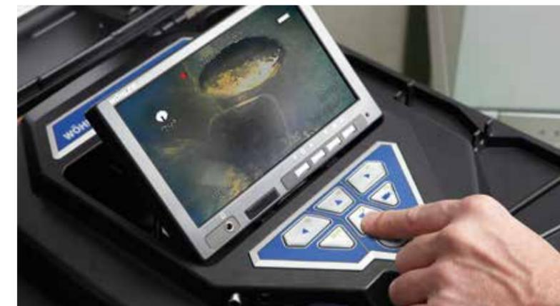
Neben der digitalen Meterzählung wird im Display zusätzlich die Lage des Kopfes angezeigt. Die Home -Taste richtet den Kamerakopf wieder in die Ausgangsposition.
