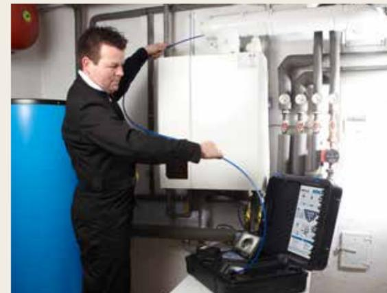
87°- Bögen werden von dem Farbkamerakopf, der um 360° drehbar und um 180° schwenkbar ist, mühelos gemeistert.
