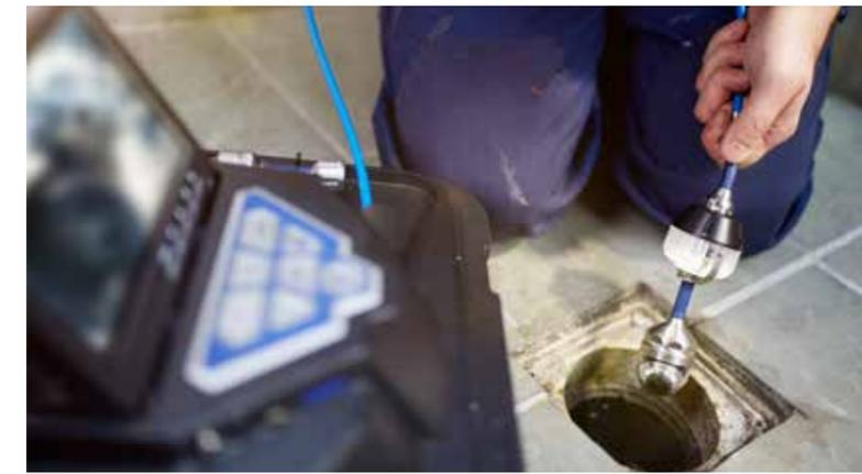
Die Kamera liefert dank der optimalen Ausleuchtung des Farbkamerakopfes und einer optionalen Zusatzbeleuchtung selbst im Dunkeln gestochen scharfe Bilder aus dem Inspektionsbereich.
