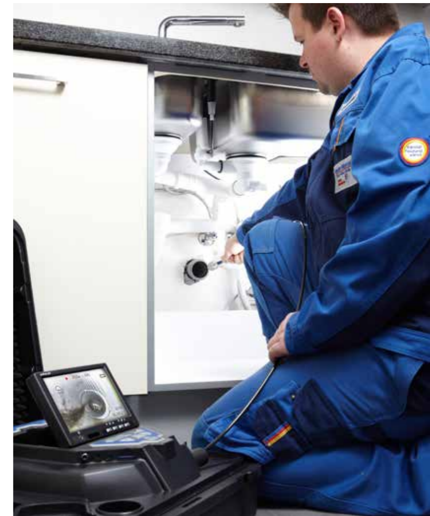
Bis 3 bar wasserdichter, robuster Farbkamerakopf mit \varnothing 26 mm lässt sich durch mehrere 87°-Bögen in Rohrleitungen von \varnothing 40 mm schieben.
