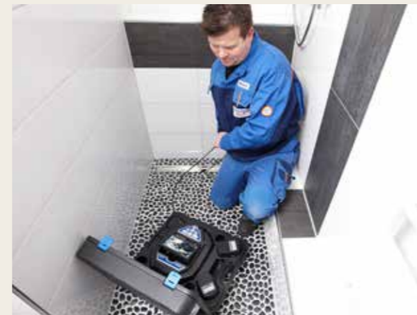
Bis 3 bar wasserdichter, robuster Farbkamerakopf mit Ø 26 mm lässt sich durch mehrere 87°-Bögen in Rohrleitungen von Ø 40 mm schieben.
