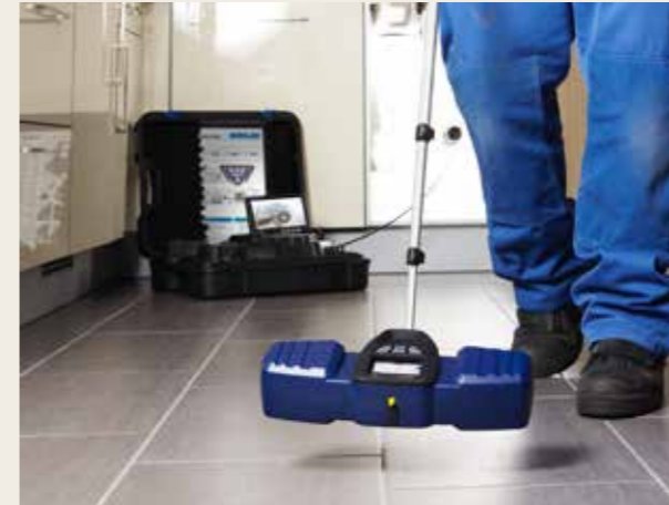
Digitale Anzeige der elektronischen Meterzählung im Display. Funkortung mit dem Wöhler L 200 Locator möglich.
