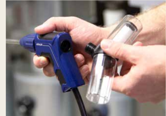
BHKW-Filter: Bei Messungen an BHKW- oder Feststoffanlagen schützt der BHKW-Filter die Sensorik.
