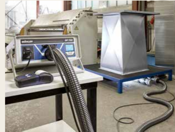
Qualitätskontrolle in der Luftleitungs- und Komponenten-Serienfertigung.
