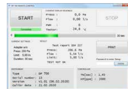
Steuerung des Wöhler DP 700 über USB-Anschluss mit optionalem Programm Remote control (z.B. bei Integration in die Serienendkontrolle).
