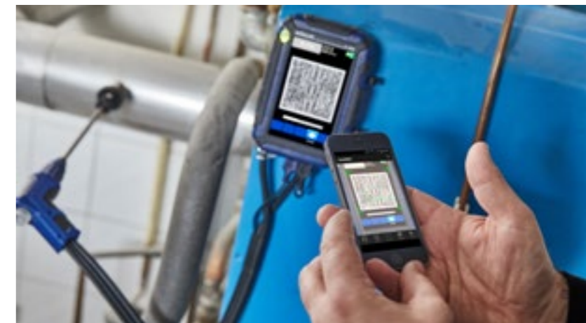
QR-Code Funktion: Eine weitere praktische Möglichkeit der Weitergabe von Messdaten an mobile Kehrbezirksverwaltungsprogramme.
