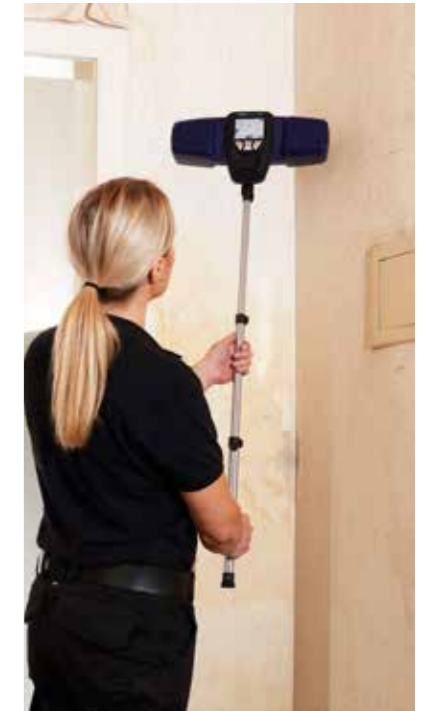
Mit dem Wöhler L 200 Locator lässt sich der Kamerakopf punktgenau orten.
