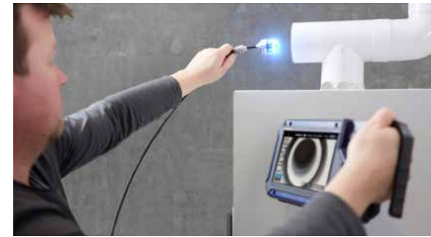
Klein, bogengängig, wasserdicht: Der Kamerakopf meistert auch die Inspektion von Abgasleitungen spielend.
