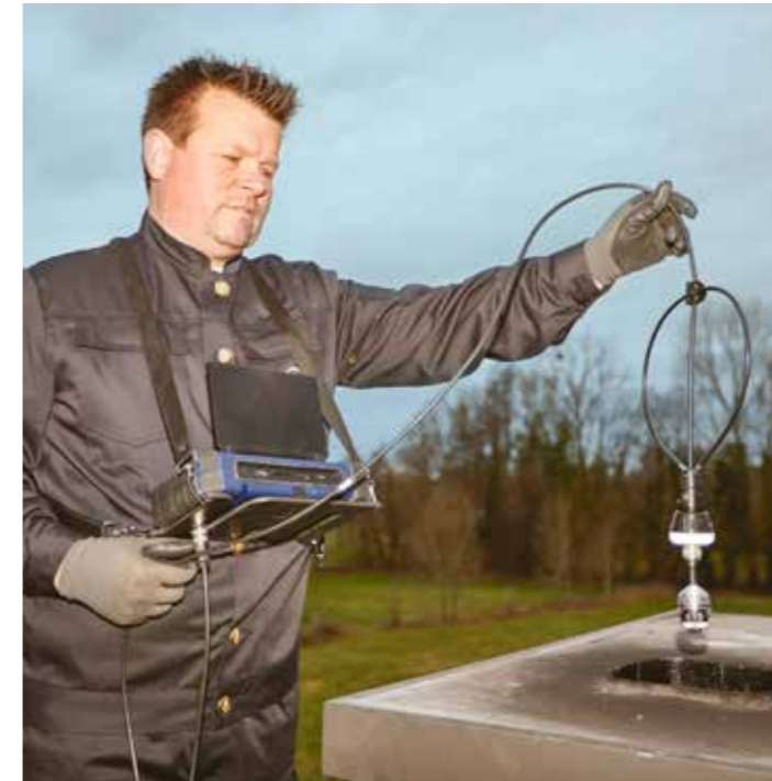
Mit dem Tragegurtsystem bleiben beide Hände für eine sichere Inspektion vom Dach aus frei.
