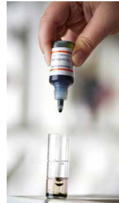
Sehr einfache und sichere Bestimmung des Härtegrads mit der im Lieferumfang enthaltenen Titrierlösung.
