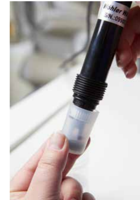
Im Set enthalten sind alle Kalibrierlösungen und eine Lagerflüssigkeit für die Sonde.
