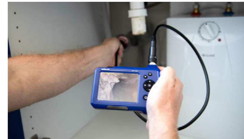
Zur einfachen Orientierung im Rohr lässt sich die Displayanzeige des Wöhler VE 320 um 180° drehen. Die flexible Sonde schafft Bögen spielend.
