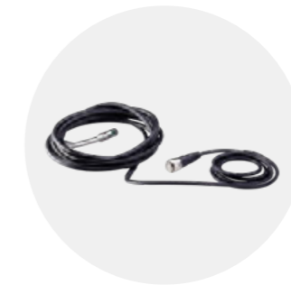
HD-Video-Endoskop-Sonde Ø 9 mm / 3 m für Abwasser-/Abgasleitungen ab Ø 15 mm, auch wasserführend
