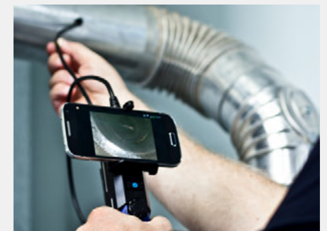
Auch auf dem Smartphone werden die Bilder des Wöhler VE 220 in hoher Qualität angezeigt. Von dort aus lassen sie sich bequem versenden.
