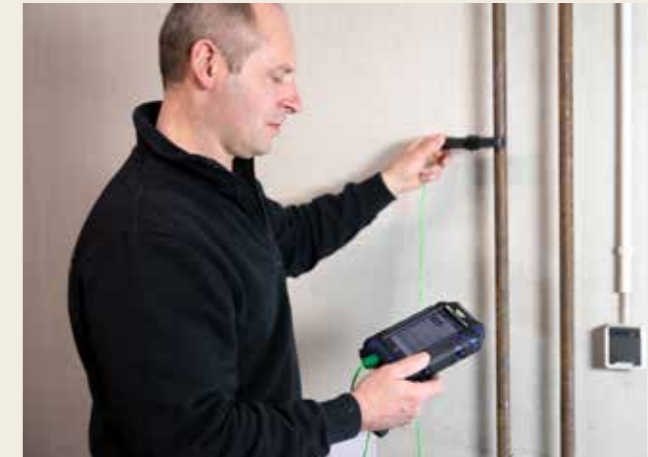
Mit der Temperaturmesszange lässt sich die Rohrtemperatur bestimmen.
