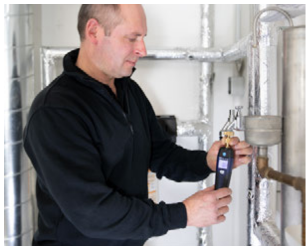
Verschiedene Verbindungsstücke zum Wöhler SC 660 ermöglichen es, das Gerät an die Wasserleitung anzuschließen.
