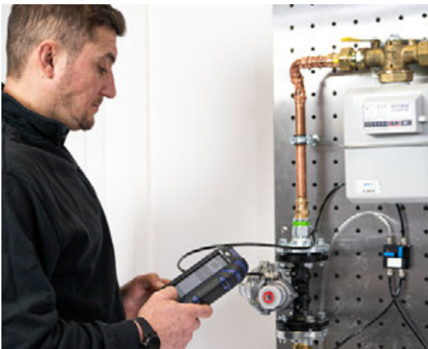
Ein eigener Menüpunkt sorgt dafür, dass die Funktionsfähigkeit des Gasreglers inkl. SAV-Prüfung in wenigen Minuten getestet werden kann.
