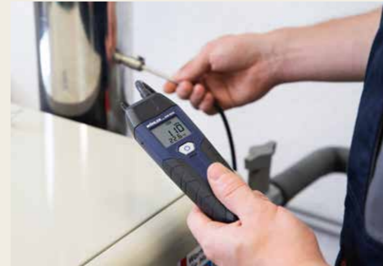
Mit dem Wöhler DM 602 arbeitest Du schnell und präzise sowohl bei Einstellungen am Brenner als auch bei der Zugmessung im Abgasrohr.
