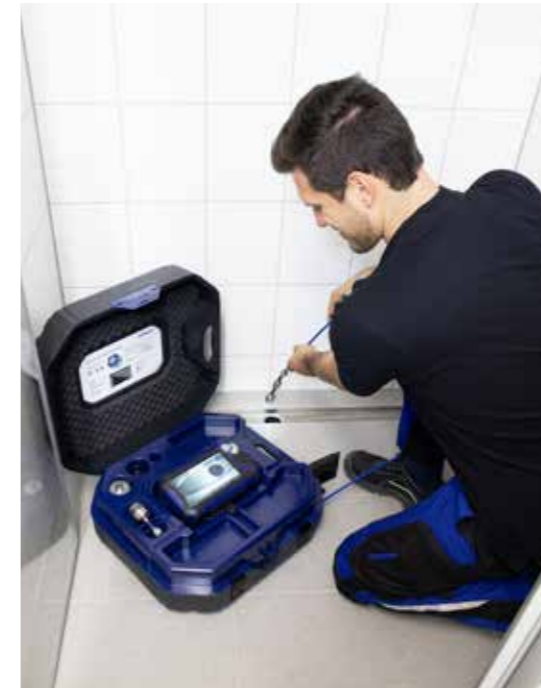
Der wasserdichte Kamerakopf ermöglicht unter anderem die Inspektion von Abwasserkanälen. Dabei sorgt der integrierte Blendschutz auch bei starker Sonneneinstrahlung für beste Sicht auf den Monitor.
