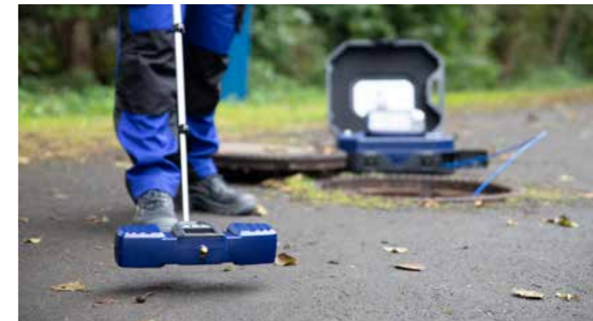
Mit dem Wöhler L 200 Locator lässt sich der Kamerakopf punktgenau orten.
