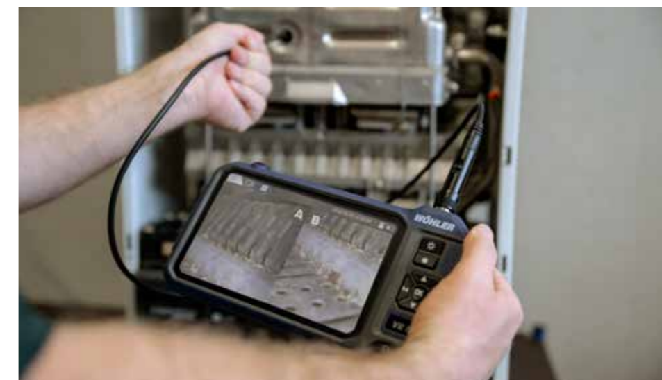
Mit dem Splitscreen Modus lassen sich auf einem Blick gleich beide Kamerabilder der Kombisonde anzeigen
