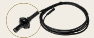
HD-Video-Endoskop-Kombisonde (3 Kameras) Ø 25 mm / 10 m / 0° / 2 x 90° mit Rollenführung Artikel-Nr. 11418
