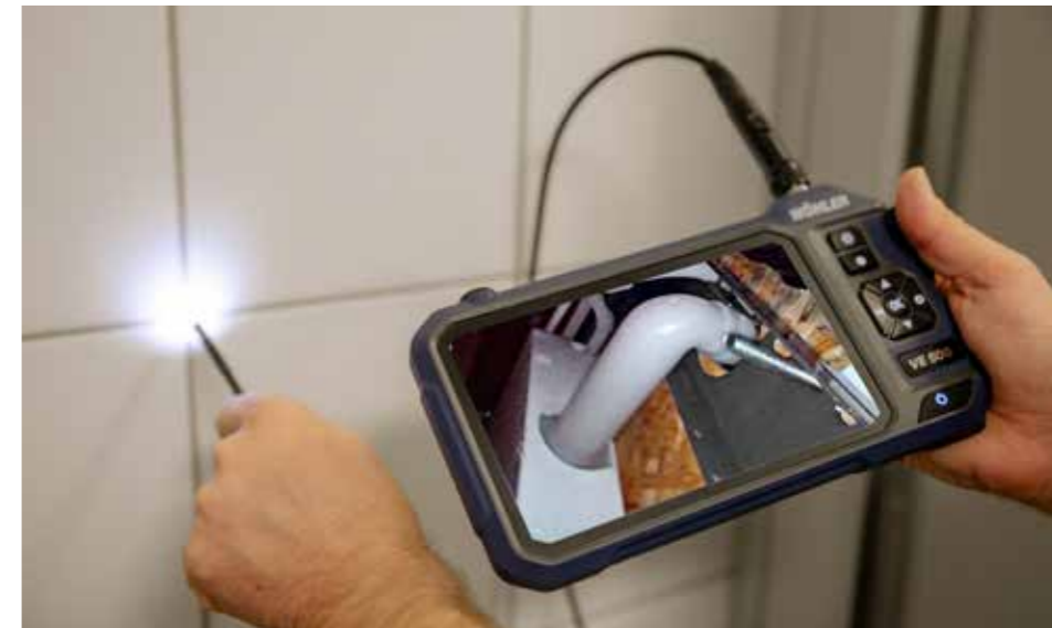
Bereits eine \varnothing 4 mm Öffnung in einem Fliesenkreuz reicht aus, um die Installation hinter der Wand zu begutachten.
