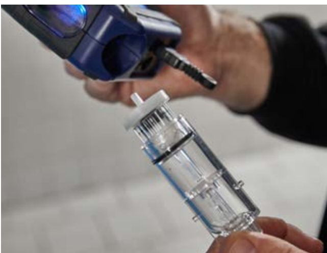
Einfache Wartung Kondensatfalle kann zum Wechseln von Watte- und Wasserstopffilter leicht herausgezogen werden.
