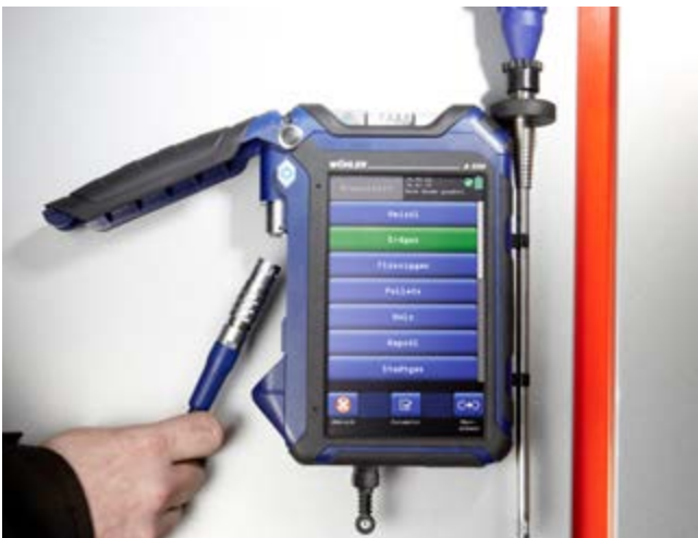
Komfortable Steckverbindung (Wöhler A 550) Temperatur, Abgasanalyse und Zug – viele Funktionen mit nur einem Schlauch: Einfach drauf stecken und die schützende Abdeckung wieder herunterklappen.
