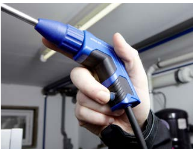
Start-/Stopptaste an der Sonde (Wöhler A 550) Beim Wöhler A 550 können Sie an schwierigen Mess-Orten bequem mit einem Knopfdruck die Messung auch über die Sonde starten und stoppen.
