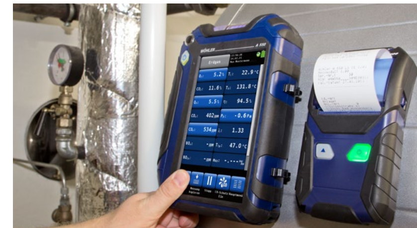
Komfortabel & praktisch: Die Messergebnisse lassen sich komfortabel vor Ort ausdrucken. Mit starken abmagneteten werden Messgerät und Drucker an der Feuerstätte befestigt, so dass die Hände zum Arbeiten frei bleiben.
