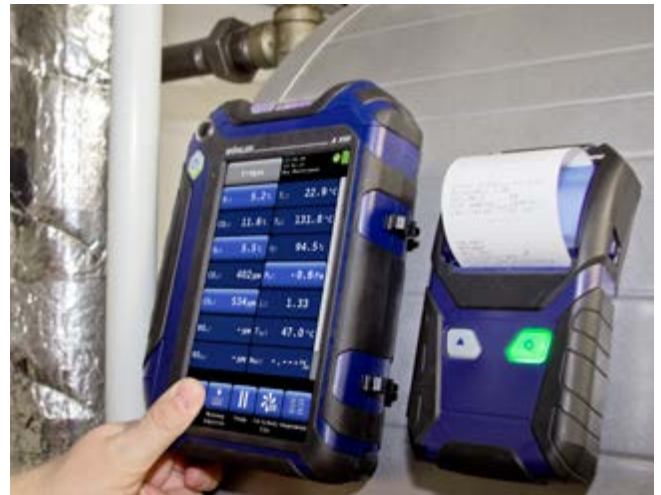
Komfortabel & praktisch Die Messergebnisse lassen sich komfortabel vor Ort ausdrucken. Mit starken Haftmagneten werden Messgerät und Drucker an der Feuerstätte befestigt, so dass die Hände zum Arbeiten frei bleiben.
