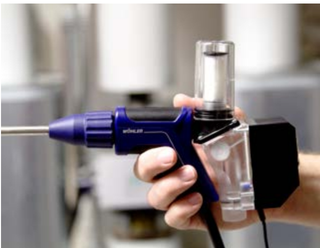
Peltierkühler Der Peltierkühler dient zur aktiven Kühlung des Abgases bei Langzeitmessungen, so dass dem Abgas das Kondensat schon entzogen werden kann, bevor es in das Messgerät eintritt.
