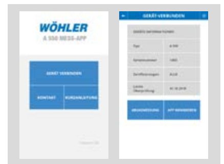
Wöhler A 550 App (Android) Inkl. Grafikfunktion, Möglichkeit zur Online-Messung sowie zum Export der Daten in Excel/als PDF oder in ein Kehrbezirks-verwaltungsprogramm.
