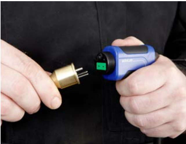
Für jede Anwendung die richtige Sonde (Wöhler A 550) Ob Abgas-, Ringspalt- oder Q_A -Mittelwertmessung, mit wenigen Handgriffen steckt beim Wöhler A 550 die passende Sonde.
