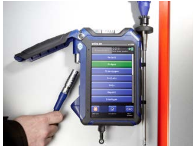
Komfortable Steckverbindung (Wöhler A 550) Temperatur, Abgasanalyse und Zug – viele Funktionen mit nur einem Schlauch: Einfach drauf stecken und die schützende Abdeckung wieder herunterklappen.
