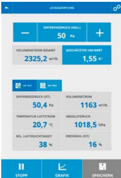
Alle Messwerte werden übersichtlich dargestellt. Messungen der Lufttemperatur und Luftfeuchte sind bereits integriert.
