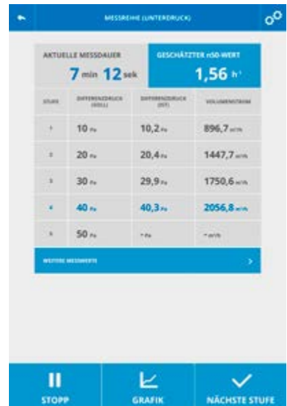
Die Wöhler BC 600 führt die komplette Messreihe (Über- und Unterdruck) gemäß DIN EN ISO 9972 und DIN EN 13829 vollautomatisch durch.
