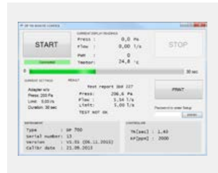
Steuerung des Wöhler DP 700 über USB-Anschluss mit optionalem Programm Remote control (z.B. bei Integration in die Serienendkontrolle).
