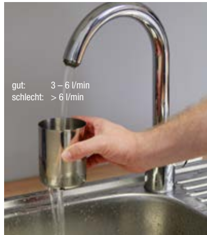
2. Durchfluss-Messbecher Unnötigen Wasserverbrauch aufdecken
