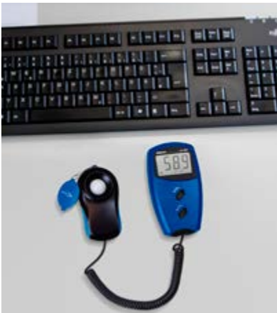
4. Wöhler LX 300 Luxmeter Bedarfsgerechte Beleuchtungsstärke sicherstellen
