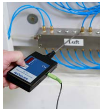
9. Wöhler UL 23 Ultraschall-Lecksuchgerät Druckluftleckagen orten
