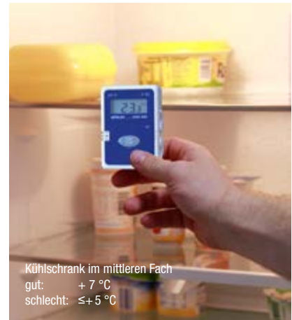
3. Wöhler LOG 220 Temperaturlogger Optimaltemperaturen sicherstellen (Kühlung, Heizung)
