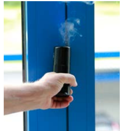
6. Nebelpistole Wärmeverlust/Zugluft an Gebäuden und Anlagen sichtbar machen
