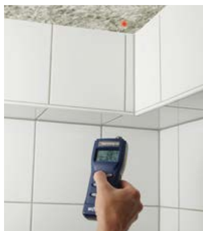
8. Wöhler IR Hygotemp 24 Wärmebrücken erkennen, Kondensation und Schimmel vermeiden
