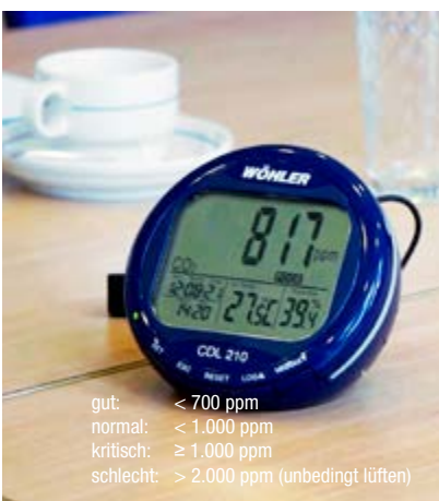
7. Wöhler CDL 210 CO 2 -Datenlogger Lüftungsverhalten optimieren
