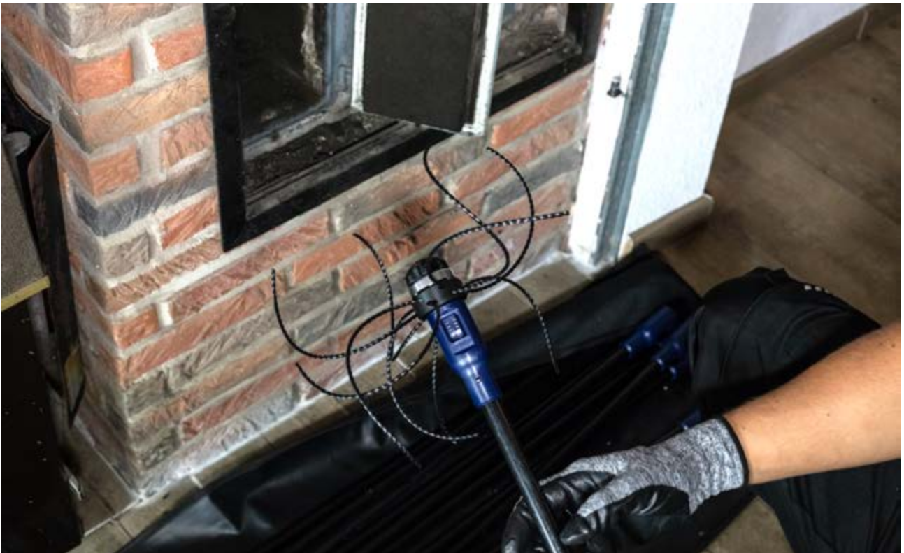
Alternativ kann der Universalrotationskopf mit Fäden genutzt werden. Zur besonders intensiven Reinigung bringen Sie die Stange mit einem Akkuschauber oder einer Bohrmaschine zum Rotieren.
