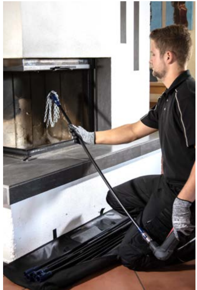
Der Universalrotationskopf lässt sich einfach mit Ketten bestücken. So ist selbst hartnäckiger Ruß für Sie kein Problem mehr.
