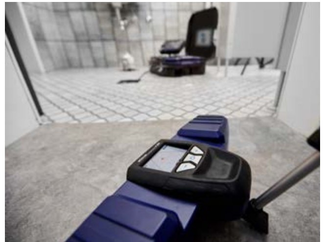
Mit dem Wöhler L 200 Locator lässt sich der Kamerakopf punktgenau orten.
