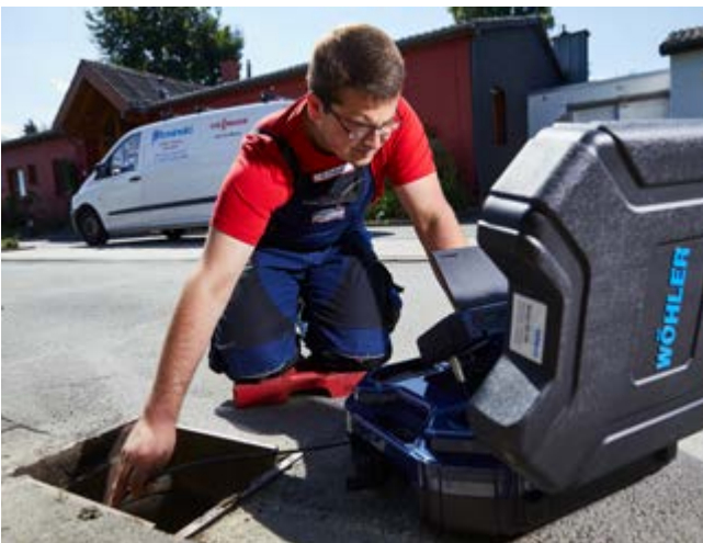
Der wasserdichte Kamerakopf ermöglicht unter anderem die Inspektion von Abwasserkanälen. Dabei sorgt der integrierte Blendschutz auch bei starker Sonneneinstrahlung für beste Sicht auf den Monitor.
