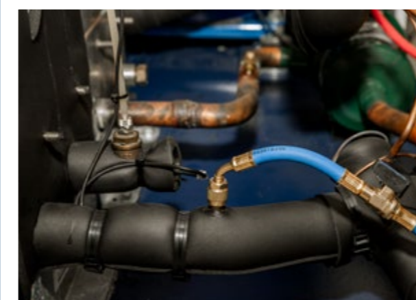
Anschlussschläuche mit Kugelhähnen zum schnellen Verschließen und Öffnen des Kältemittel-Durchflusses
