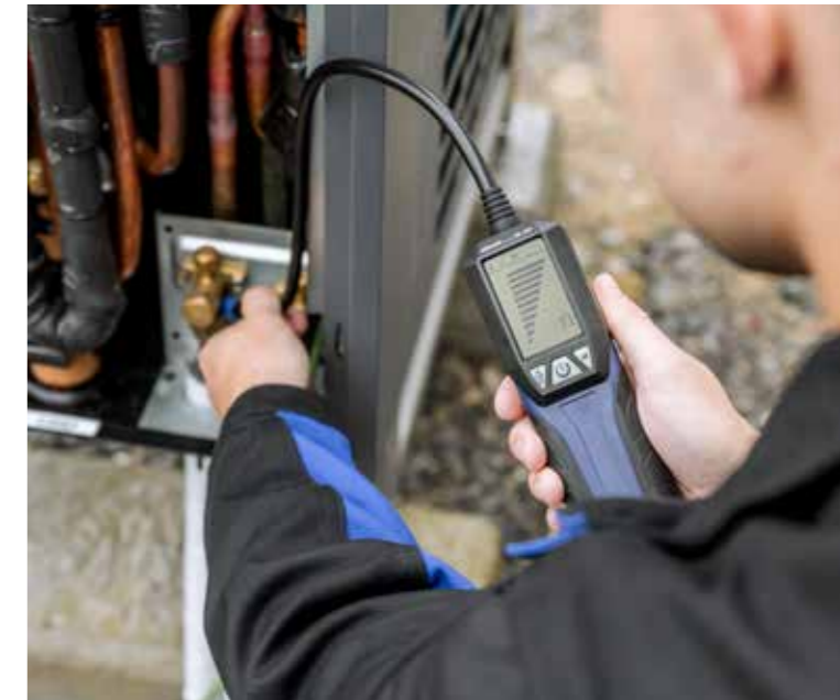
Präzise Detektion von allen gängigen Kältemitteln.
