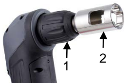
Fig. 57: Esempio di un avvitatore (non compreso nella fornitura) con il raccordo per trapano
