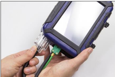
Abb. 3: Kondensatfalle aus Gerät ziehen
