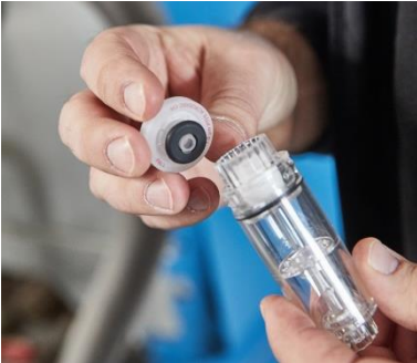
Abb. 7: Wasserstopfilter wird auf Filterhalter gesteckt
