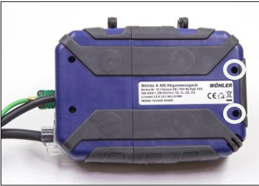
Abb. 10: Geräteunterseite – Servicedeckel, Kreuzschlitzschrauben zum Lösen des Servicedeckels mit Kreis markiert.
