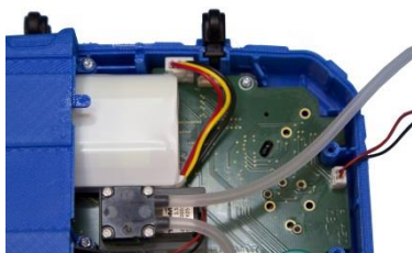
Abb. 16: Akku Wöhler A 450 angeschlossen, Sensoren sind entnommen, O 2 -Sensor Stecker und Gaswegschlauch sind noch angeschlossen.
