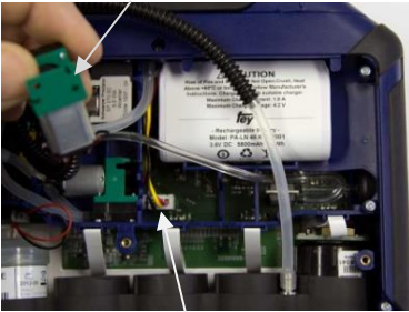
Abb. 15: Entnehmen der Freispülpumpe vor dem Akkutausch
