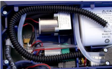
Abb. 16: Wellschlauch korrekt verlegt
