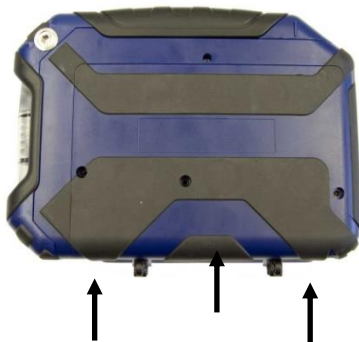
Abb. 9: Geräteunterseite – Druckpunkte zum Öffnen der Abdeckung
