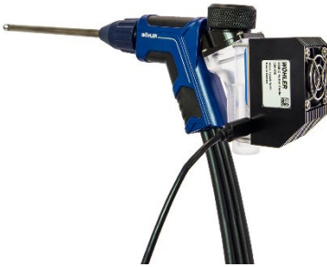
Abb. 2: Peltierkühler an Sondengriff angeschlossen
