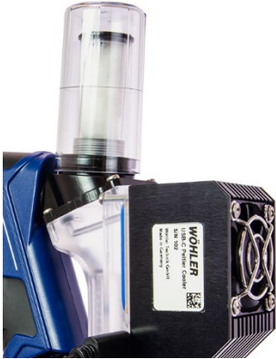
Abb. 3: Peltierkühler mit Wattefilter
