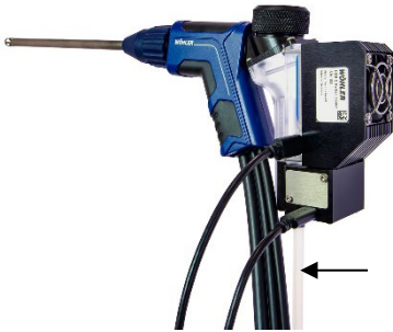
Abb. 5: Peltierkühler und Kondensatpumpe auf Sondengriff montiert, transparenter Kondensatschlauch mit Pfeil gekennzeichnet
