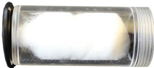
Abb. 8: Filterhülse mit Watte befüllt
