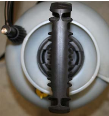
Abb. 7: Pumpengriff geöffnet (Pumpposition)
