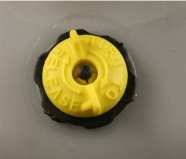
Fig. 17: Robinet de décharge ouvert
