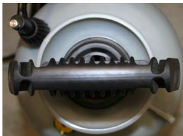
Fig. 13: Poignée de la pompe verrouillée.
