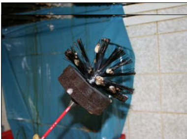
Abb. 8: Ablösung von Fett mit Bürsten
