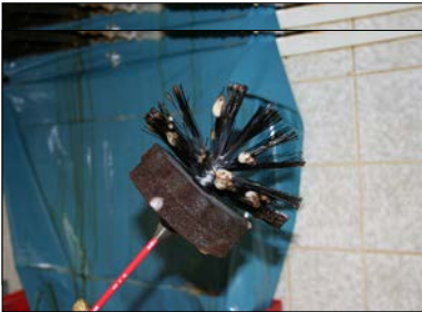
Fig. 19: Dégraissage avec des brosses
