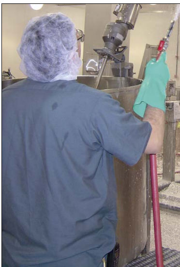
Fig. 11: Vêtements de protection lors du travail avec le canon à mousse
