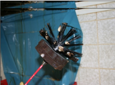
Fig. 13: Dégraissage avec des brosses
