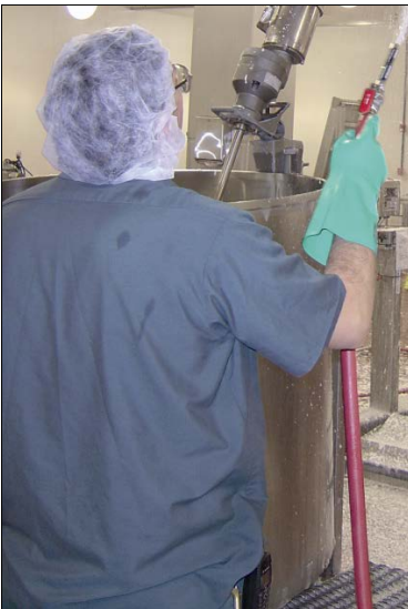
Abb. 4: Schutzkleidung bei der Arbeit mit dem Schaumreinigungsgerät
