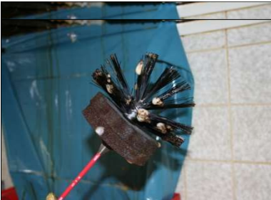
Fig. 13: Dégraissage avec des brosses
