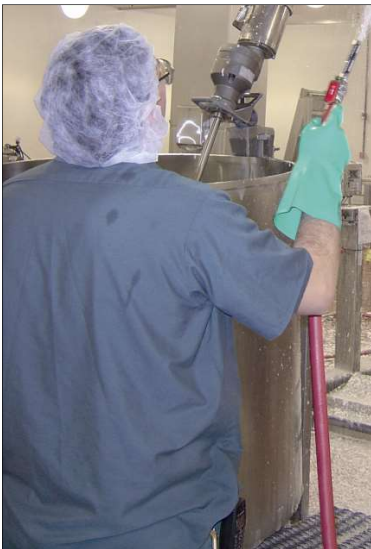
Abb. 4: Schutzkleidung bei der Arbeit mit dem Schaumreinigungsgerät
