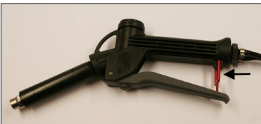
Abb. 1: Spritzengriff arretiert, Griffarretierung mit Pfeil markiert
