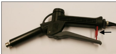
Abb. 1: Spritzengriff arretiert, Griffarretierung mit Pfeil markiert
