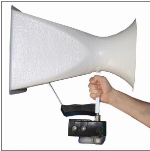
Abb. 3: Wöhler Funkmesssonde A 600 mit Messtrichter K 75
