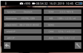
Afb. 15: Infomenu met SOM (firmware van de camera) en CAM (versie van de camerakop)
