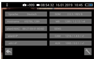
Fig. 11: Menu d'informations avec SOM (micro logiciel de la caméra) et CAM (version de la tête de caméra)
