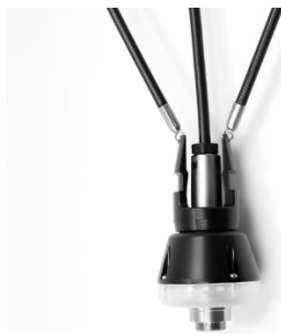
Abb. 6: Zusatzbeleuchtung auf Kamerafederführung geschraubt
