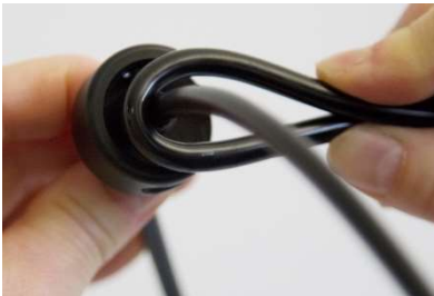
Abb. 8: Kamerakabel wird in Klemmhalterung gelegt
