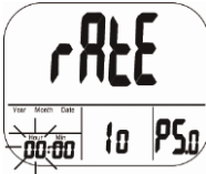
Abb. 19: Einstellen der Abtastrate (Stunden)
