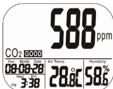
Abb. 3: Display nach dem Einschalten
