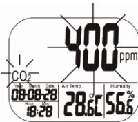
Abb. 21: Display während der CO 2 -Kalibrierung
