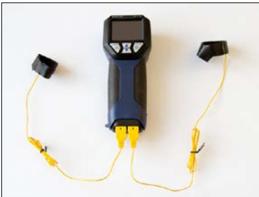
Abb. 3: Anschluss von zwei Temperatursensoren
