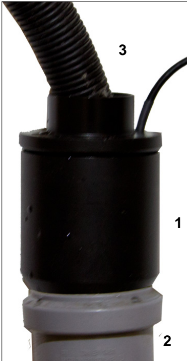
Abb. 17: Einsetzen der Kondensatzählereinheit in den Abfluss
