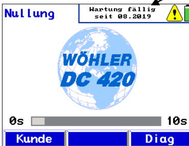
Abb. 40: Warnhinweis, da Wartungsintervall überschritten
