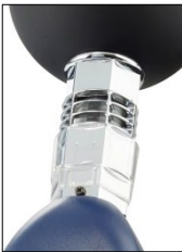
Abb. 2: Sensorschutz zum Messen nach unten geschoben
