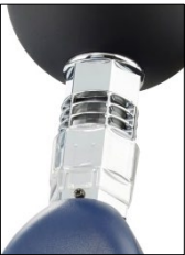
Fig. 4: Pour effectuer des mesures, la protection de capteur doit être poussée vers le bas.
