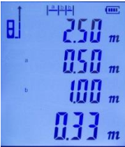
Abb. 18: Beispiel einer Absteckmessung
