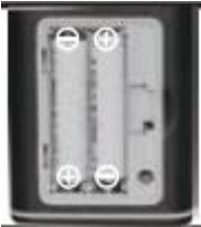
Abb. 7: Position der Batterien
