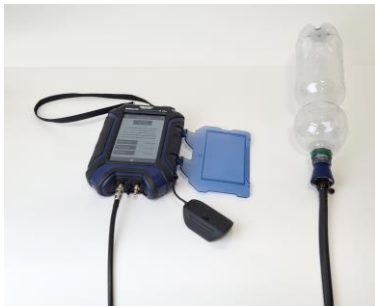
Abb. 10: Dichtheitstest mit PET-Flasche
