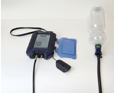
Abb. 10: Dichtheitstest mit PET-Flasche
