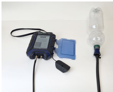
Afb. 10: Dichtheidstest met petfles
