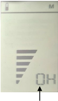
Figura 40: Display durante l'azzeramento manuale del sensore
