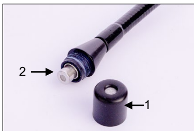
Fig. 33 : Capuchon de protection (1) et pointe de la sonde avec capteur inséré (2)
