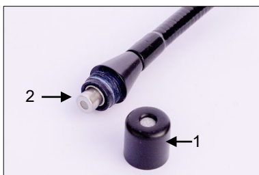
Fig. 57: Beschermkap (1) en sondepunt met geplaatste sensor (2)
