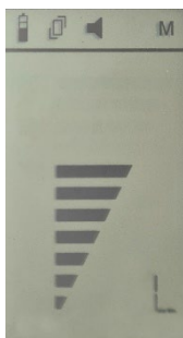
Fig. 43: Rilevamento del refrigerante
