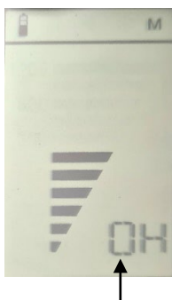
Fig. 52: Display tijdens handmatig nulstellen van de sensor
