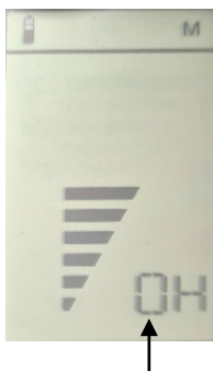
Fig. 28 : Écran pendant la mise à zéro manuelle du capteur
