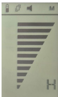
Fig. 41: Display con sensibilità impostata su alta
