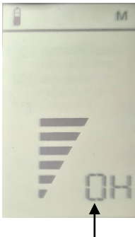
Abb. 5: Display während der manuellen Sensornullung
