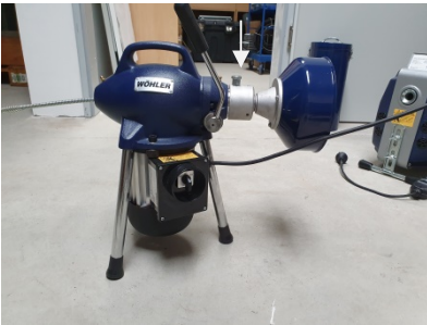
Abb. 10: Adapter am Gerät befestigt, Rastbolzen mit Pfeil gekennzeichnet
