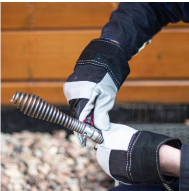
Abb. 7: Schnappverschluss lösen, um Bohrer von Spirale zu trennen
