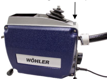
Abb. 13: Schutzschlauch abziehen, Rastbolzen mit Pfeil markiert
