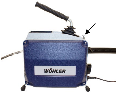
Abb. 7: Schutzschlauch über Spirale gezogen, Rastbolzen mit Pfeil markiert
