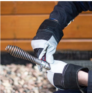
Abb. 9: Lösen des Schnappverschlusses mit Schlüssel
