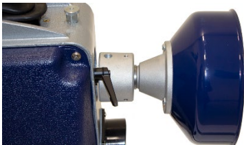
Abb. 11: Adapter am Gerät fixiert
