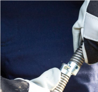
Abb. 8: Schnappverschluss zusammenschieben, um Bohraufsatz zu befestigen
