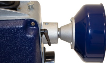
Abb. 14: Adapter am Gerät fixiert
