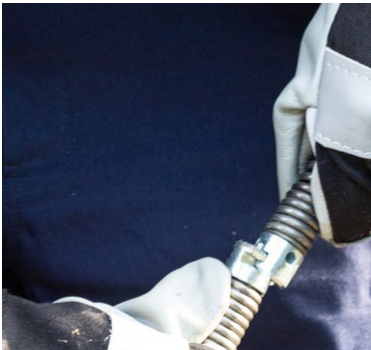
Abb. 4: Reinigungsvorsatz auf Spirale klicken
