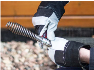
Abb. 5: Reinigungsvorsatz von Spirale lösen
