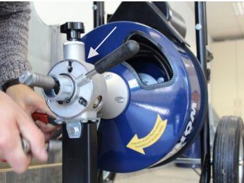
Abb. 10: Vorschubeinheit mit Pfeil markiert
