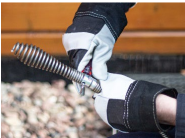
Abb. 5: Reinigungsvorsatz von Spirale lösen
