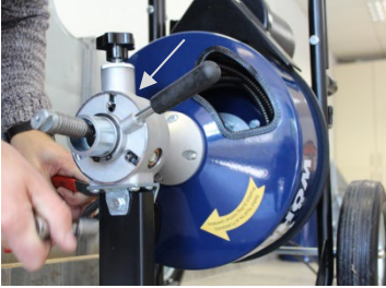
Abb. 10: Vorschubeinheit mit Pfeil markiert
