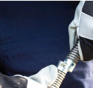
Afb. 14: Reinigingshulpstuk op spiraal klikken
