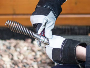
Afb. 15: Reinigingshulpstuk van spiraal verwijderen
