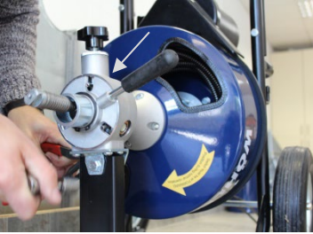
Afb. 20: Toevoerenheid met pijl gemarkeerd
