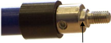
Abb. 2: Anschluss Reinigungsaufsatz; Einkerbung durch Pfeil markiert
