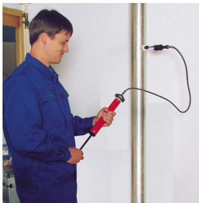
Image 3: Prélèvement des gaz de fumée
