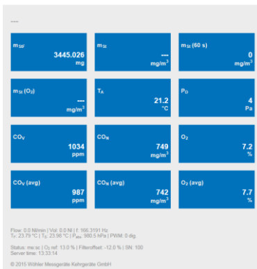
Abb. 40: Anzeige der Messdaten Wöhler SM 500 auf einem PC oder mobilen Endgerät
