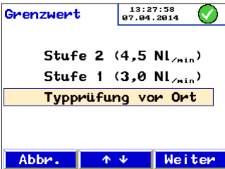
Abb. 14: Display des Wöhler SM 500 zur Auswahl des Grenzwertes
