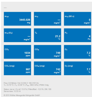
Abb. 39: Anzeige der Messdaten Wöhler SM 500 auf einem PC oder mobilen Endgerät
